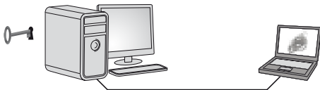
Einzelserver-Architektur mit Web Manager Client-Zugriff für 15.000 Datenpunkte
